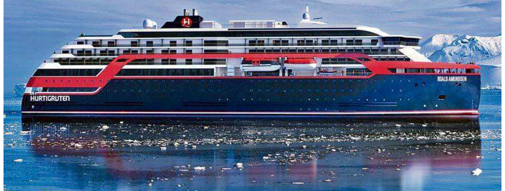
Die MS Roald Amundsen ist ein hybrides Kreuzfahrtschiff und fährt mit einem LNG-Antrieb. FOTO: HURTIGRUTEN
