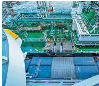
Ein Tankschiff versorgt die „Aida Nova“ mit Flüssiggas. FOTO: AIDA CRUISES
